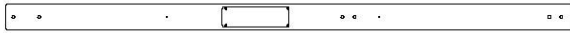
E3 | PATA DE TORRE CON ETIQUETA - W2A03400 (x1) | 1 3/8" x 3 3/8" x 74" (36 x 86 x 1880)
