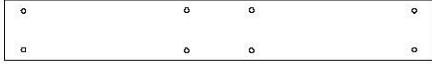
G1 | SOPORTE DE VIGA DEL COLUMPIO - W102365 (x1) | 1" x 5 1/4" x 37 3/8" (24 x 134 x 950)
